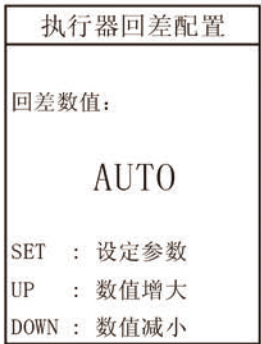
Figure 10 执行器回差配置界面
