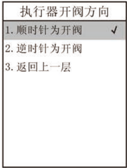
Figure 9 执行器开阀方向配置界面
